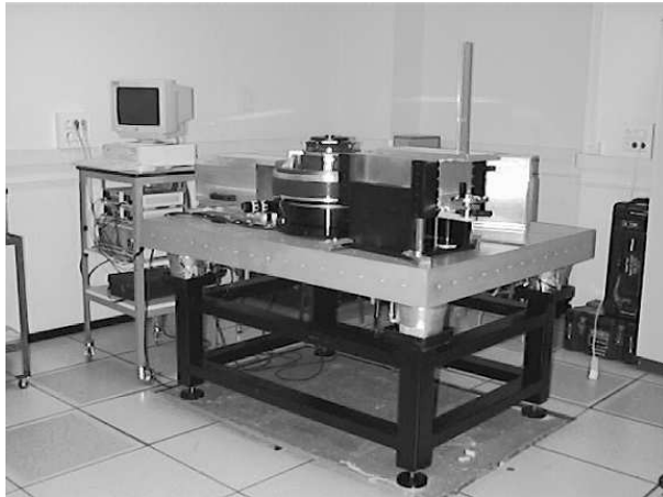
Fig. 1. - Nouvelle implantation du plateau de référence angulaire (LNE-Paris).
